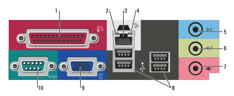
1 connecteur parallèle Permet de connecter un périphérique parallèle, tel qu'une imprimante. Si vous avez une imprimante USB, raccordez-la à un connecteur USB.
