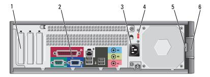
1 slot per schede Questi slot consentono di accedere ai connettori delle schede PCI e PCI Express installate.
